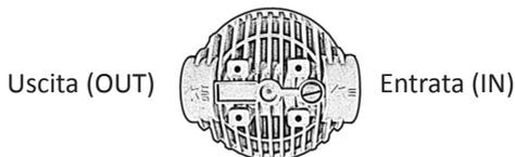
4. Collegate il pre-filtro anti-sedimenti alla tubatura a monte dell'addolcitore rispettando l'entrata e l'uscita dell'acqua.
